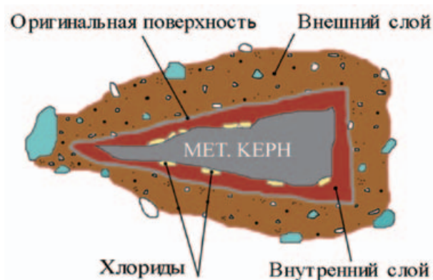
Рис. 1. Схематическое изображение разреза корродированного железного объекта
