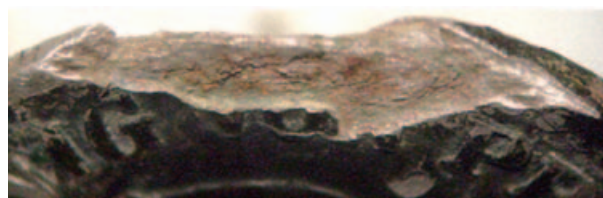
Фото 3. Серебряный грош 1868 г. Разрушения, вызванные интеркристаллической коррозией
