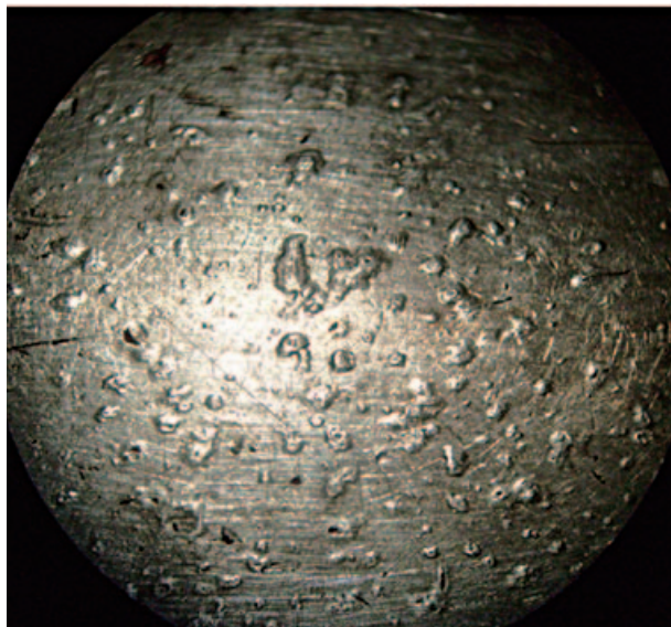
Фото 10. Отслаивание слоя серебрения в результате коррозии меди
