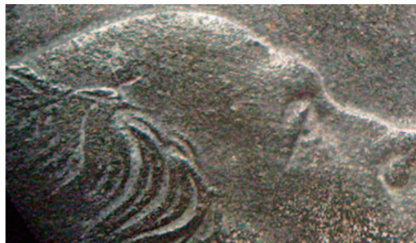
Фото 11. Темная сульфидная патина в результате коррозии меди
