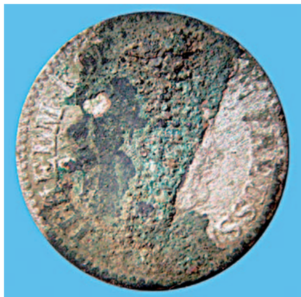
Фото 4. Зеленые продукты коррозии меди на поверхности монеты из серебряного сплава
