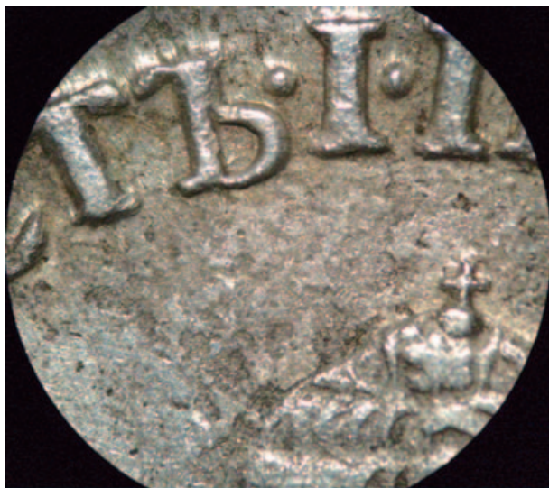
Фото 2. Полуполтина 18 в. На изъеденной коррозией поверхности монеты видны крупинки металла.
