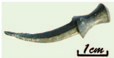
Рис. 20. На данном образце хорошо виден литейный шов.
